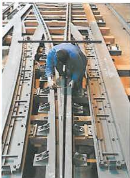
Сборка стрелочного перевода на заводе Vossloh Cogifer в Рейшхоффане
